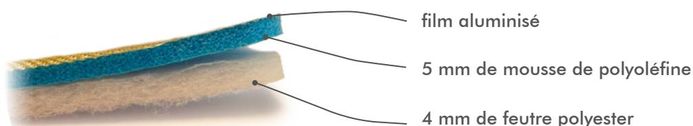
Insulit Bi+9 est constitué d'un film aluminisé réfléchissant très résistant et d'une double structure à ressort feutre et mousse pour une efficacité assurée. Le feutre permet de corriger les basses fréquences de 100 à 500 Hz et la mousse corrige les moyennes et hautes fréquences de 500 à 5000 Hz. Ce complexe mince de  $\pm 9$  mm obtient des résultats acoustiques supérieurs aux produits beaucoup plus épais en panneaux ou en vrac.
